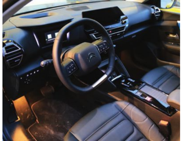
TRE SKJERMER: Den viktigste informasjonen samles på head up display, og i en 5-tommers skjerm foran rattet, samt en 10-tommers skjerm for annen info midt på dashbordet. FOTO: IVAR ENGERUD
